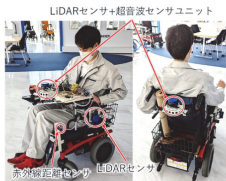
図2 安全装置を搭載した電動車いす
