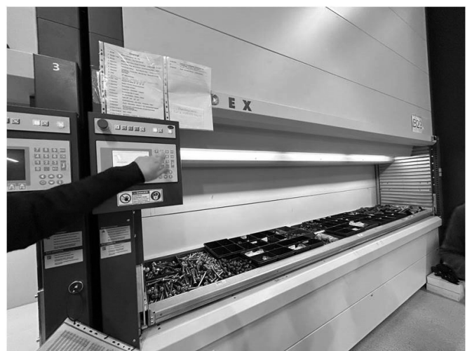
図10 機械式パーツ保管庫
