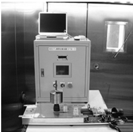
図 1 先ゴムの摩擦試験実施を目的として NITE で開発された装置
